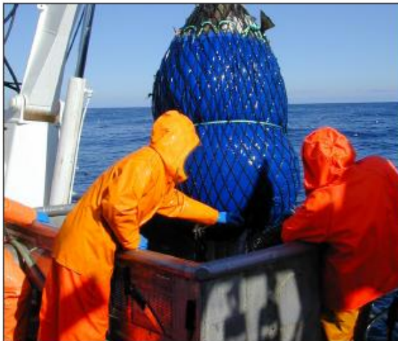
Bilde 23: Løftesekk med innmontert pressensylinder. Magebånd montert midt på løfteposen for å begrense volum og vekt av fisk i pose.
