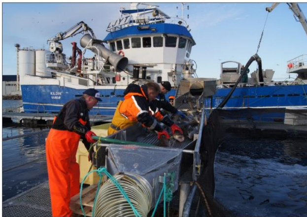
Bilde 48: Mottak for levende fisk må være laget slik at fisken bremses langsomt opp, helst på et fuktig og glatt underlag. Operatørene av anlegget må være trent og øvet i å oppdage fisk som er skadet eller for utmattet/sløv til å overføres til mottaksmerkene.
